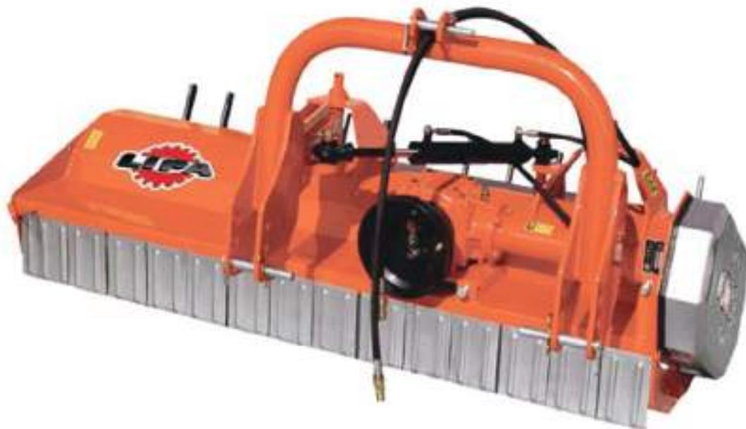
Il Trinciattutto TLS è un'attrezzatura utilizzata per la trinciatura di erba e sarmenti, di potatura di vigneti, frutteti e uliveti. Dispone di attacco a tre punti ed è applicabile a trattori cingolate e gommate. Il trinciattutto TLS si caratterizza per lo spostamento idraulico trasversale (max 40 cm) che ne consente l'impiego in posizione decentrata per lavori di accostamento alle colture.
